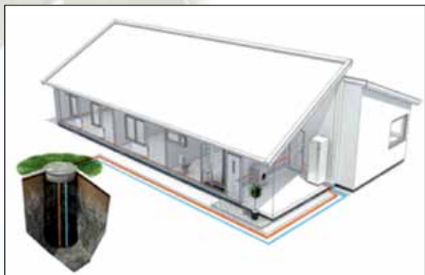
Вертикальные грунтовые зонды – отбирают тепло от грунта вертикально.
