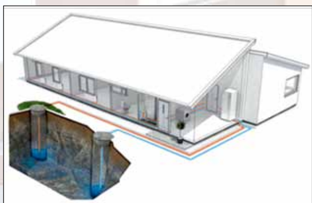
Вертикальные грунтовые зонды – отбирают тепло от грунта вертикально.
